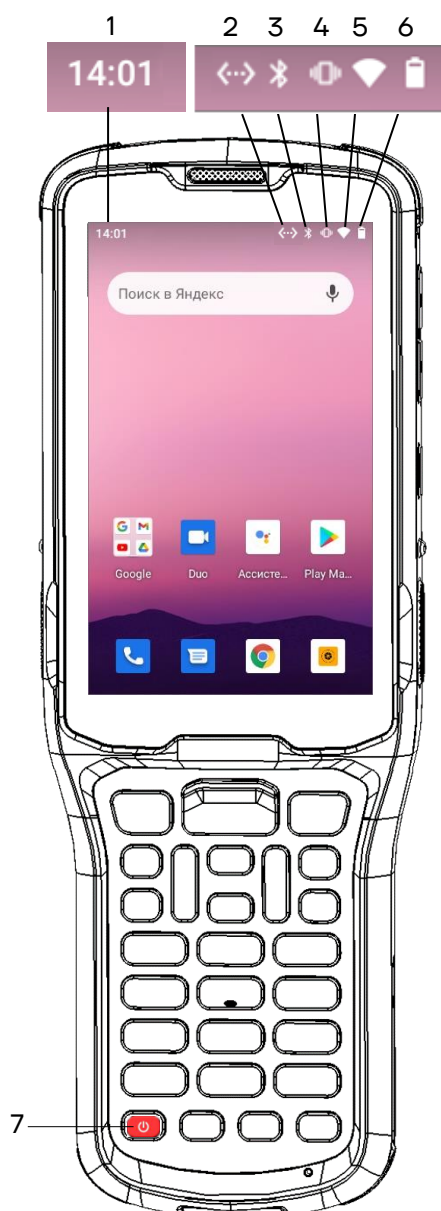
Рисунок 10. Расположение основных индикаторов ТСД
