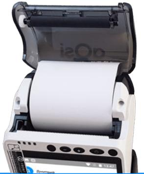
Встроенный термопринтер чеков с высокой скоростью печати
